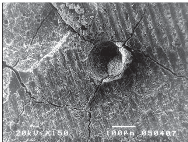
Слика 4. Ваздушни мехур на адхезиву након уклањања бравице (увеличање \times 150 )
