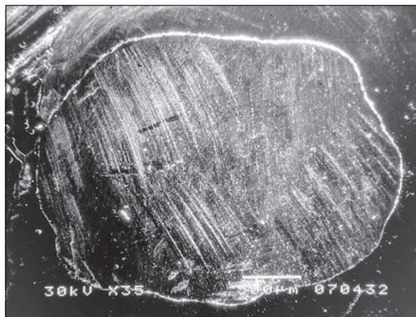
Слика 1. Добра ивична адаптација хибридног композита за глеђ након примене тотално нагризајућег система – цео обим рестаурације. Нема пукотине на споју композита и глеђи (прва група из дејонизоване воде). Оригинални СЕМ (увеличање 35х).
