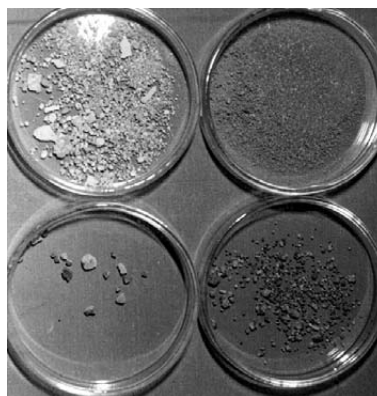
СЛИКА 3. Изглед измрвљеног камена. FIGURE 3. Disintegrated stone.
